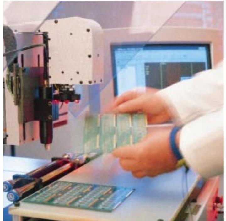
Das Polar Instruments RITS automatische Impedanztestsystem wird zur Messung von mittleren bis hohen Stückzahlen eingesetzt. Die Messung beruht auf dem Industriestandard CITS in Kombination mit einer Flying Probe-Automation um den Durchsatz zu erhöhen und bisher nicht erreichte Meßgenauigkeit, Zuverlässigkeit und Wiederholgenauigkeit zu erzielen.
