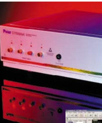
Das CITS beruht auf TDR-technik zur Impedanzmessung und es meldet automatisch, wenn eine Messung außerhalb des spezifizierten Toleranzfelds liegt. Es verarbeitet die Daten automatisch und zeigt den Impedanzverlauf über der Leiterbahnlänge als Meßkurve.
